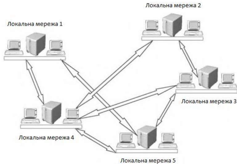
Рисунок 1.6 – Мережа з сітчастою топологією
